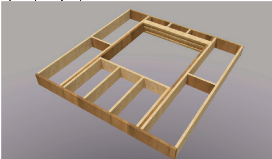
Prefabrykowany element ściany zewnętrznej z otworem okiennym
